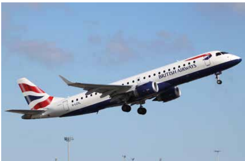
Figura 2 | O jato comercial E-190E1 tem capacidade para até 100 assentos em classe única e pode cumprir rotas de até 4,5 mil km totalmente carregado
