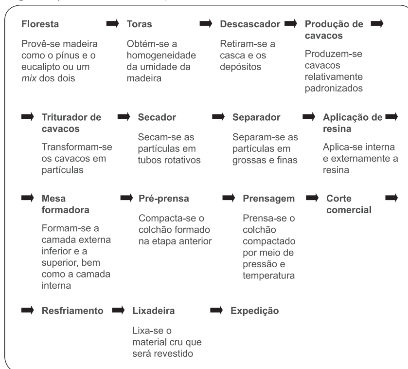
Figura 2 | Processo de fabricação do MDP
