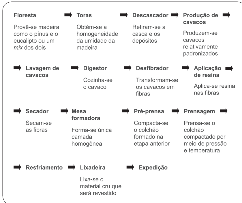
Figura 3 | Processo de fabricação do MDF
