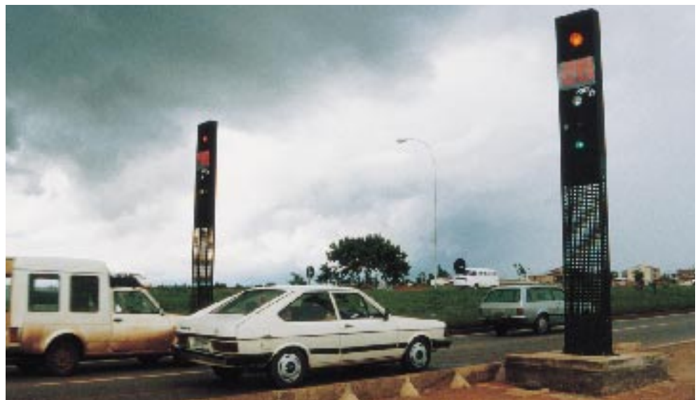
A lombada eletrônica identifica e registra o veículo que ultrapassa o limite de velocidade definido para a via, sendo um importante instrumento para a segurança viária (Brasília).
