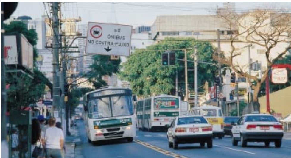
A implantação de faixas exclusivas de ônibus no contrafluxo em corredores de tráfego reduz o percurso e o tempo de viagem (av. Brig. Luiz Antonio, São Paulo).
