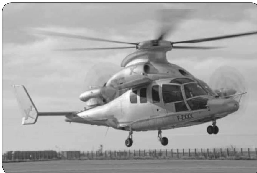
Foto de divulgação Eurocopter. © Copyright Eurocopter. All rights reserved. <[www.eurocopter.com](http://www.eurocopter.com)>. Nota: O helicóptero X3 da Eurocopter representa uma plataforma tecnológica. É um veículo experimental, não fabricado em série, e está sendo utilizado para o desenvolvimento de tecnologias inovadoras vislumbradas para a próxima geração de helicópteros.
