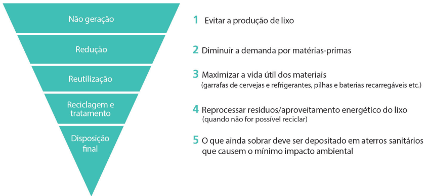
Figura 4 | Ordem de prioridade na gestão e no gerenciamento de resíduos sólidos, com base na Lei 12.305/2010
